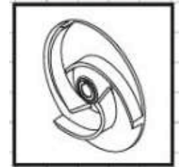
Impulsor tipo abierto en acero inoxidable.
