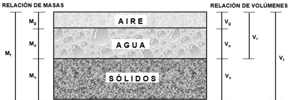
Figura N° 3.- Relaciones de volumen y masa de los componentes del suelo
